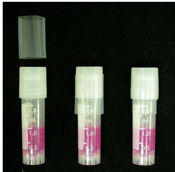
圖3、冷凍小管封膜圖示
