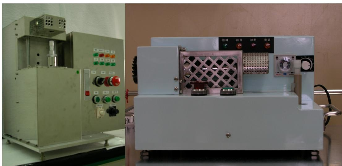
圖4、冷凍封膜機第一代(左)與第二代(右)雛形機。
